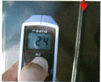
断熱αコート塗布面24°C (仕上げ2液弱溶剤型ウレタン使用)
